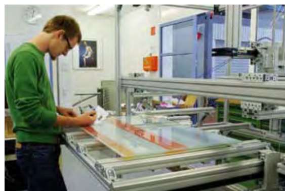
Abb. 2: Befüllvorgang an einem 60 cm x 100 cm großen Farbstoffsolarmodul. Zu diesem Zweck haben wir gemeinsam mit dem Fraunhofer IAO eine produktionsnahe Herstellungseinheit entwickelt und aufgebaut.
