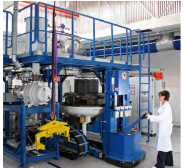
Abb. 2: Mit unserer Kristallisationsanlage zur Erstarrung von Blöcken mit variablen Größen von 20 kg bis zu 250 kg können wir durch individuelle Prozesssteuerung verschiedene Ansätze zur gerichteten Erstarrung erforschen. Im Bild ist der geöffnete Ofen mit einem Graphit-Stütztiegel für eine Blockgröße von 85 kg Si zu sehen.
