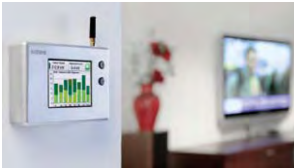
Abb. 1: Das Display erhält über ZigBee-Funk Energiedaten und zeigt Tageswerte, Viertelstundenwerte und Echtzeit-Leistungswerte an.
