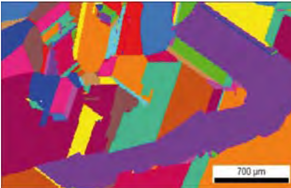
Abb. 1: Kristallorientierungsmessung mit Electron Back Scatter Diffraction (EBSD) im Rasterelektronenmikroskop. Durch die automatische Auswertung von Interferenzen der am Kristallgitter gebeugten Elektronen können wir die Kristallorientierungen in multikristallinem Silicium mit hoher Ortsauflösung bestimmen.
