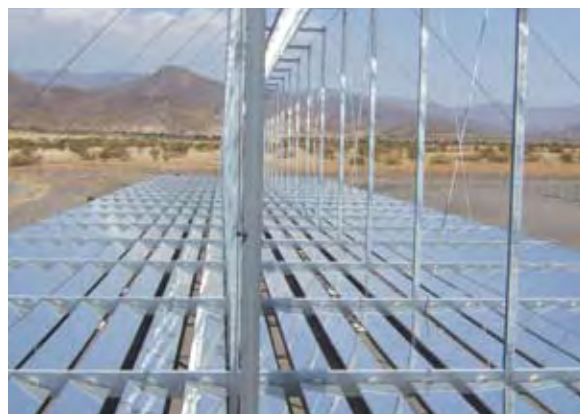
Abb. 3: FRESDEMO-Versuchskollektor auf der Plataforma Solar de Almería, Spanien. Die Vermessung dieses Kollektors dient als Grundlage für die techno-ökonomische Bewertung der Fresnel-Technologie (Basisfall).
