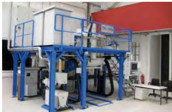
Abb. 1: Industrielle Kristallisationsanlage (VGF) zur Herstellung von multikristallinen Siliziumblöcken.
