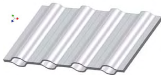
Abb. 3: Darstellung einer Wärmeübertragerstruktur für Kompressionswärmepumpen mit Luft als Wärmequelle. Das angewandte Fertigungsverfahren kombiniert Vorteile aus dem Bereich quer angeströmter Flachrohr-Wärmeübertrager und längs durchströmter Lamellen-Rohr-Wärmeübertragern.
