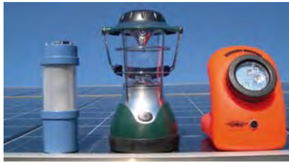
Abb. 1: Verschiedene photovoltaische LED-Leuchten. Die linke und die rechte sind mit je einer weißen Hochleistungs-LED, die mittlere mit einer Vielzahl von Kleinleistungs-LEDs bestückt. Tagsüber wird der integrierte NiMh-Akku über ein kleines Photovoltaikmodul mit ca. 5 W Leistung aufgeladen. Je nach Dimensionierung werden nächtliche Leuchtdauern von 3–8 h erreicht. Die Qualität der Photovoltaikmodule und Akkus ist relativ gut, die mittlere Abweichung vom Nennwert beträgt minus 10 %.
