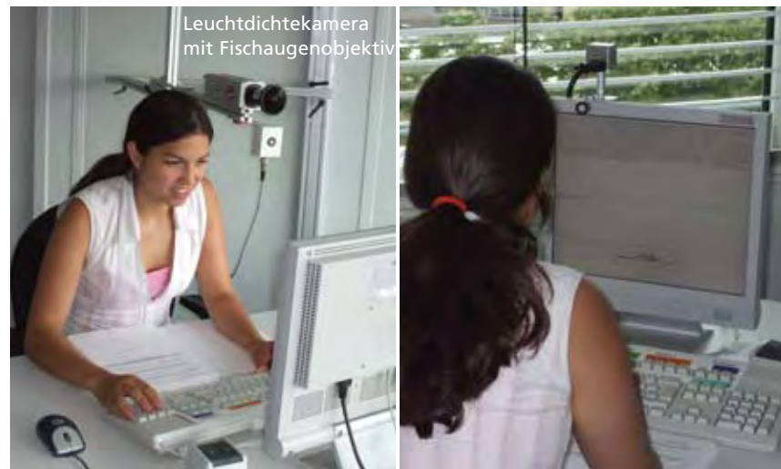
Abb. 2: Messaufbau der Testraumversuche am Fraunhofer ISE: Die Leuchtdichtekamera zur Erfassung der Leuchtdichteverhältnisse im Sichtbereich befindet sich in ca. 15 cm Abstand zur Kopfposition des Probanden (siehe linkes Bild). Die Probanden müssen mehrere Tests am Bildschirm (z. B. Abschreibetest, siehe rechtes Bild) durchführen und einen Fragebogen beantworten.
