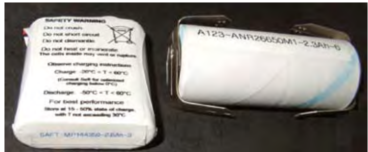
Abb. 1: Die Abbildung zeigt zwei im Rahmen des deutsch-französischen Kooperationsprojekts EMSIS modellierte Batterien. Die negative Elektrode besteht bei beiden Batterien aus Kohlenstoff, die positive Elektrode bei der linken Zelle aus \text{LiCoO}_2 , bei der rechten Zelle aus \text{LiFePO}_4 . Das entwickelte Modell lässt sich für Batterien unterschiedlichster Kapazitäten und Technologien nutzen.
