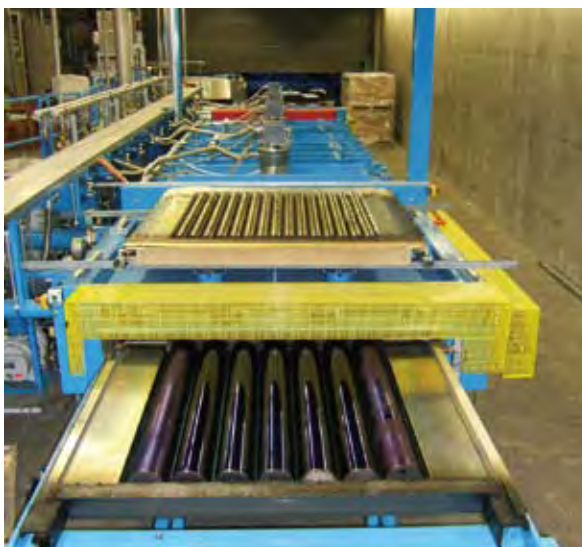
Abb. 2: Für den Fresnel-Demonstrationskollektor auf der Plataforma Solar de Almería beschichteten wir 100 m Absorberrohr mit der von uns entwickelten selektiven Absorberschicht. Das Bild zeigt die für eine Pilotproduktion taugliche Sputteranlage mit den beschichteten Absorberrohren.
