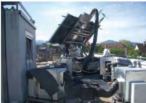
Abb. 1: Luftkollektorteststand, installiert zur Leistungsmessung auf dem Dach des Fraunhofer ISE. Man erkennt den auf dem Sonnentracker aufgebauten Kollektor und davor die einzelnen Komponenten des Testkreises: zwei Ventilatoren (saug- und druckseitig), zwei Volumenstrommessgeräte und der Wärmetauscher, der über einen geregelten Thermostaten die Betriebstemperatur des Luftkollektors während der Wirkungsgradmessung vorgibt.
