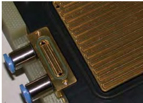
Abb. 1: Anoden-Flowfield einer Brennstoffzelle mit Referenzelektrodenkonfiguration, die eine separierte Messung der Anoden- und Kathodenimpedanzspektren ermöglicht.
