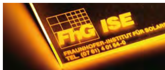
Abb. 5: An dieser Probe aus den frühen Jahren des Fraunhofer ISE sieht man, wie das Licht im Fluoreszenzkonzentrador zu den Kanten geführt wird.
