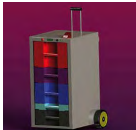
Abb. 4: 3-D-Ansicht des modularen RBZS. Das Reformersmodul befindet sich oben (rot) und darunter das BZ-Modul (violett). Die anderen drei Module beinhalten die Elektronik (blau) und die Brennstofftanks. Für einen leichten Transport hat das System Rollen und einen Griff. Zum Verladen können einzelne Module herausgenommen werden. Zum Befüllen können die Tanks einfach getauscht werden.
