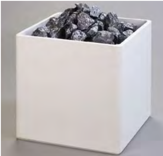
Abb. 1: Die Kristallisation unterschiedlichster Feedstock-Qualitäten stellt unseren ersten Forschungsschwerpunkt entlang der Si-Wertschöpfungskette dar. Zu sehen ist Feedstock in einem Quarztiegel für einen Block mit 85 kg. Der kristallisierte Block ist in der Einleitung zum Geschäftsfeld Silicium-Photovoltaik abgebildet (siehe Seite 42).
