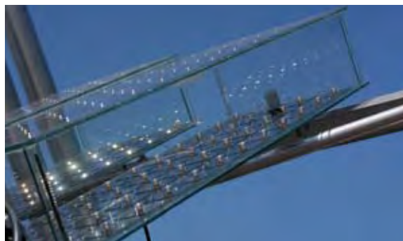
Abb. 2: FLATCON®-Modul mit reflektiven Elementen auf den Solarzellen. Die Montage erfolgte auf unserer Pilotlinie. Das Modul erreichte einen Rekordwirkungsgrad von 28,2 %.
