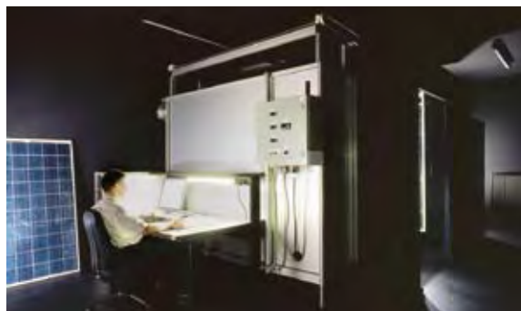
Abb. 1: Neues Labor zur Leistungsmessung von PV-Modulen.
