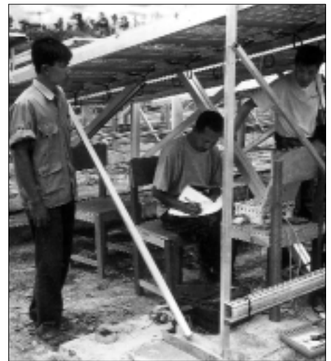
Abb. 1: Untersuchung einer technischen Anlage: Das Foto zeigt die Vermessung der PV-Stränge im Betrieb vor Ort. Die Messungen führt ein indonesischer Mitarbeiter durch.
