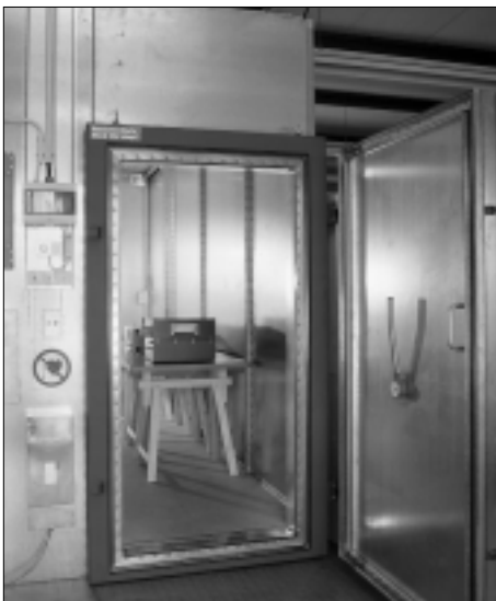
Abb. 1: Blick in die EMV-Messkammer des Fraunhofer ISE.
