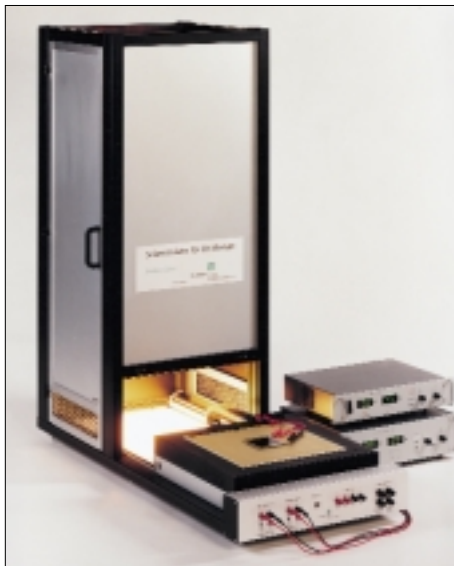
Abb. 1: Sonnensimulator zur Charakterisierung von CIS-Modulen.
