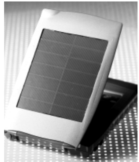
Prototyp eines solar betriebenen Organisers. Die geräteintegrierten Akkus werden von dem Photovoltaikmodul aufgeladen. (Zusammenarbeit zwischen Fraunhofer ISE, Casio Computer und AccuCell).
