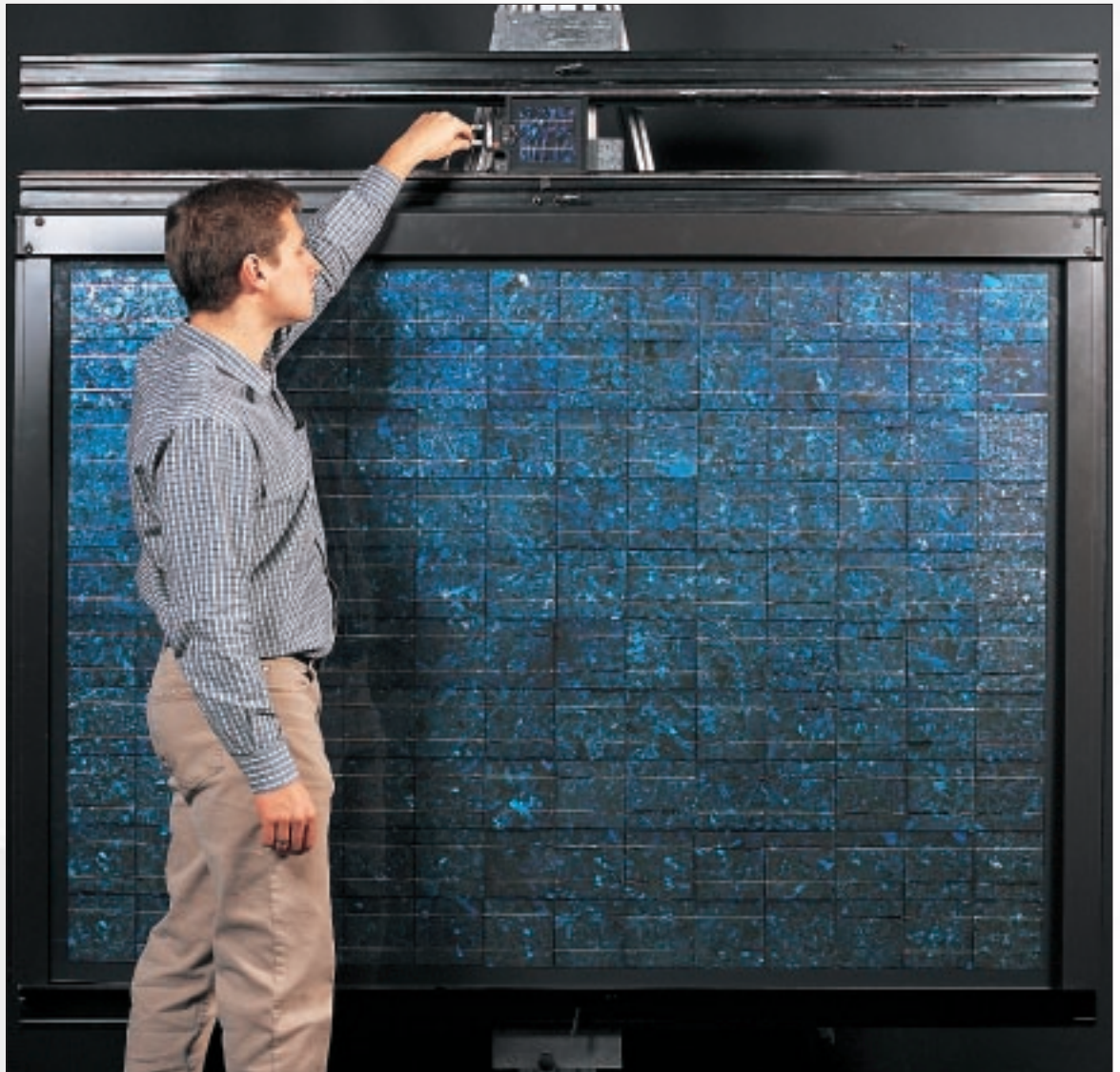
Präzisionsmessung eines 3 m 2 großen Solarmoduls mit einer Nennleistung von 290 Watt.
