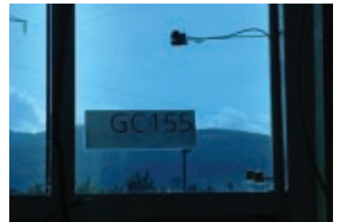
Abb. 1: Durchsicht durch eingefärbte gaschrome Verglasung mit Temperatursensoren am Fassadenteststand.
