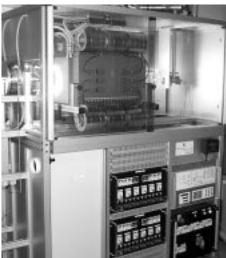
Abb. 3: Apparatur zum Abscheiden von Siliciumschichten nach dem CVD-Verfahren.
