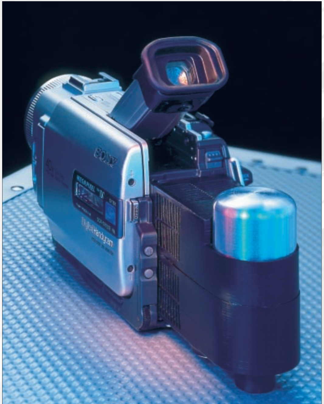
Brennstoffzellen-Energieversorgung für eine digitale Videokamera. Die »Fraunhofer-Initiative Mikrobrennstoffzelle« entwickelte neuartige Bipolarplatten, den Brennstoffzellenstack, die Systemregelung sowie die Prozesse für eine Serienfertigung (Beitrag S. 54).
