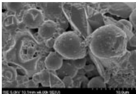
Abb. 1: Mikroskopaufnahme der Mikrokapseln im Verbundsystem.
