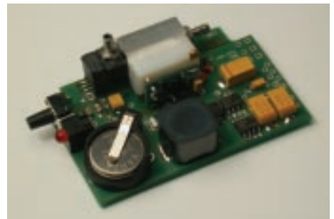
Abb. 1: DC/DC-Wandler für Brennstoffzellen-Camcorder mit 97 % Wirkungsgrad. Die Baugruppe schließt außerdem das Wasserstoffventil und eine Knopfzelle für die Startschaltung ein. Die Länge der Platine ist 50 mm.
