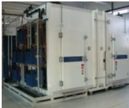
Abb. 2: Doppel-Klimaprüfkammer für Fenster und solare Fassaden am Fraunhofer ISE.
