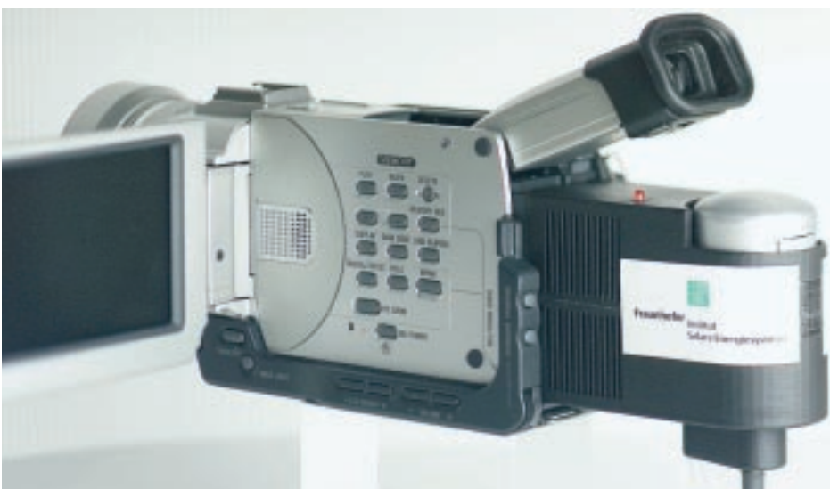
Abb. 1: Handelsüblicher Camcorder mit einem Brennstoffzellensystem als Energieversorgung. Der Zylinder rechts ist ein Metallhydridspeicher für Wasserstoff.
