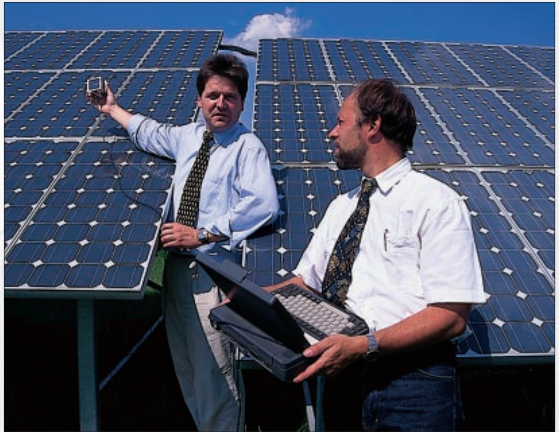
Leistungsvermessung eines Solarkraftwerks für die RWE in Essen (Beitrag S. 92).
