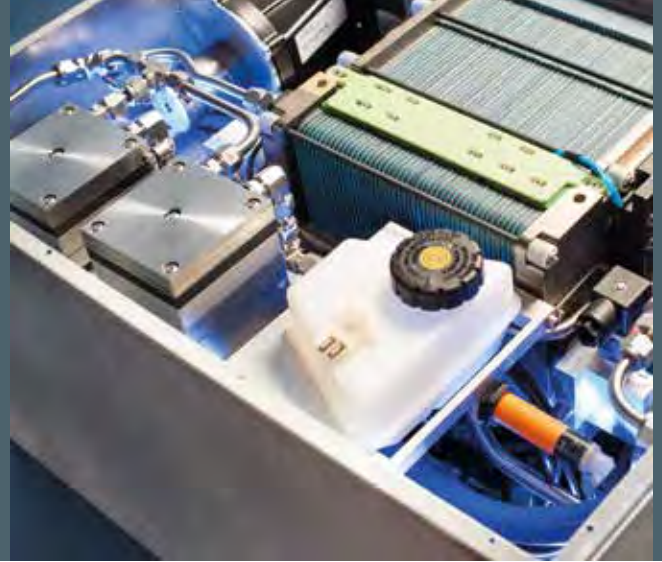
Wasserstoff-Brennstoffzellensystem zur jahreszeitlichen Energiespeicherung mit einer Ausgangsleistung von 1,5 kW.
