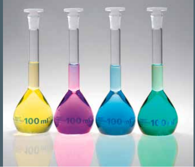
Die vier Oxidationszustände des verdünnten Vanadium-Elektrolyts (v. li. n. r.: V5+, V2+, V4+, V3+).
