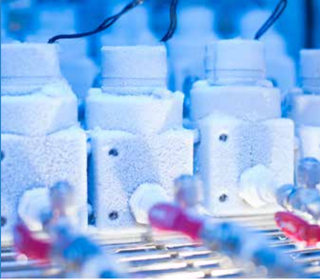
Langzeittest von Ventilen für Brennstoffzellensysteme bei tiefen Temperaturen in der Klimaprüfzelle.
