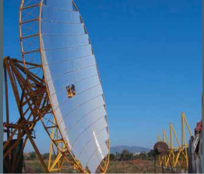
Scheffler-Reflektor zur Erzeugung von Heißdampf zum Betrieb einer 1 MW-Turbine mit Abwärmenutzung in Rajasthan, Indien.
